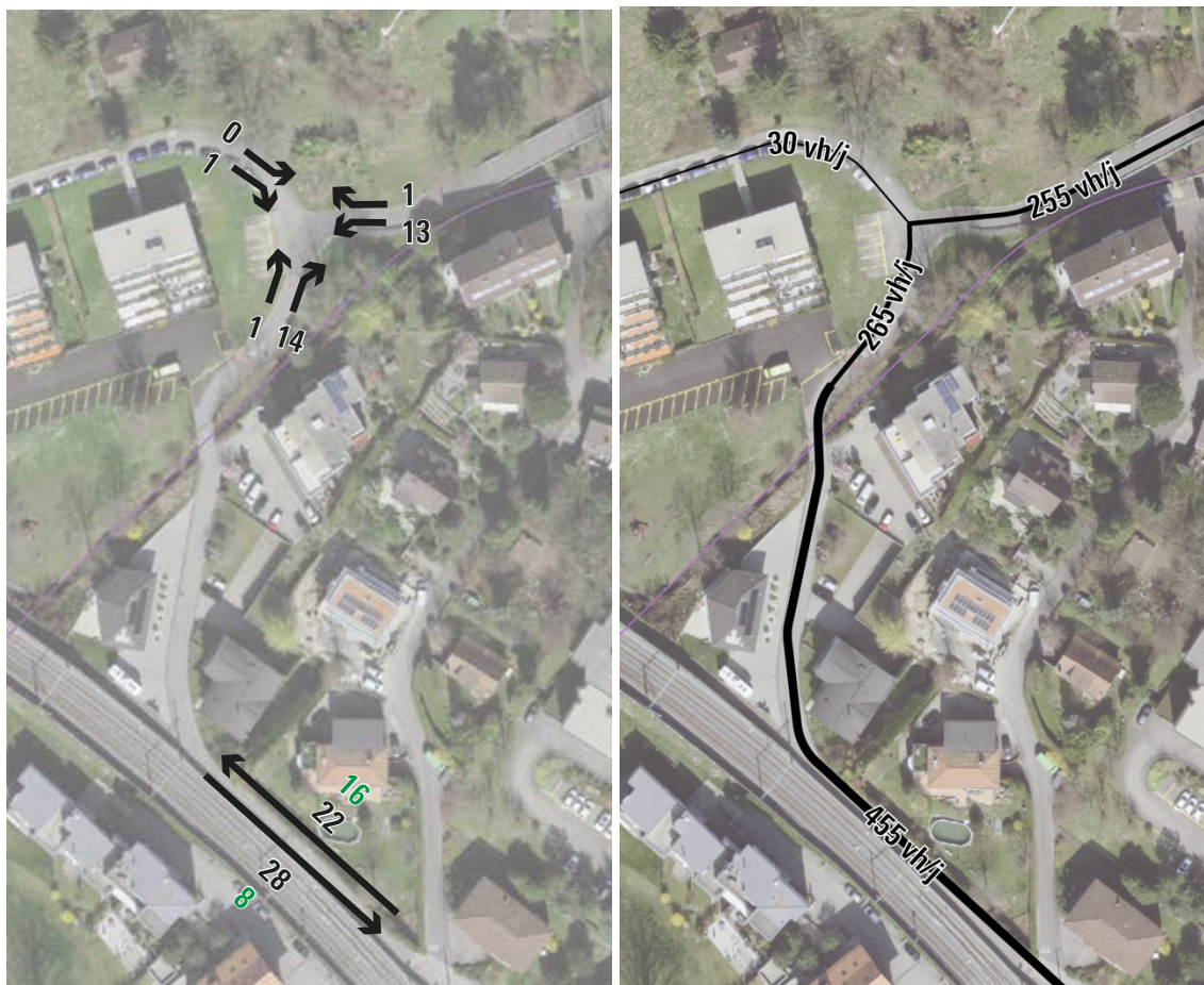
Figure 13 : A gauche : Comptages en HPS effectués le 2 février 2023 pour les points de comptage 1 et 2. Les voitures sont reportées en noir et les piétons en vert. A droite : Trafic journalier estimé selon les comptages du 2 février 2023, pour les points de comptage 1 et 2.
