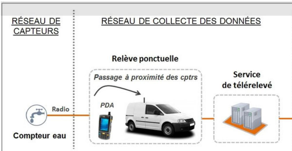
La relève à distance des compteurs de type "radio-relève" se réalise en passant à proximité de ces derniers. Ce passage peut se faire à pied ou en véhicule.
