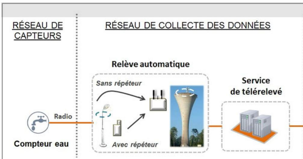
La relève à distance des compteurs de type "télérelève" se réalise quotidiennement en automatique. Ce système apporte de nombreux avantages tels que l'optimisation des rendements de réseau et le service "alerte fuite" pour l'abonné.
