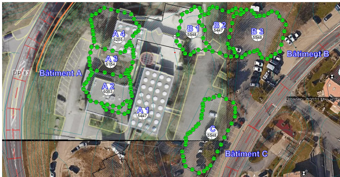
Figure 7 : Art. 31 OPB, route nationale N09 vue 2D, récepteurs et niveaux d'évaluation de jour pour les bâtiments A, B et C (Source : Vue 2D CadnaA, CSD, 2021)
